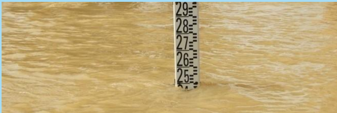
Échelle limnimétrique — suivi des niveaux d'eau des retenues stratégiques
