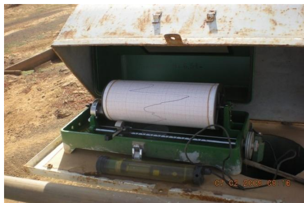
Limnigraphe enregistreur de terrain
