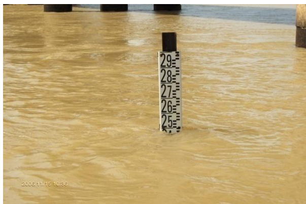
Échelle limnimétrique en station
