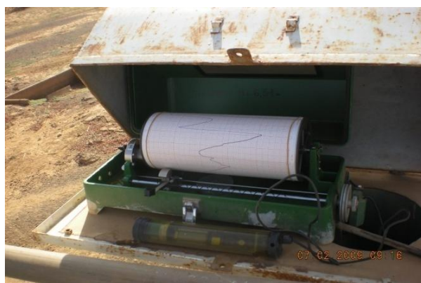
Limnigraphe enregistreur de terrain
