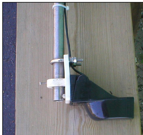
Image 3.2 – Transducteur Sonar Mite
