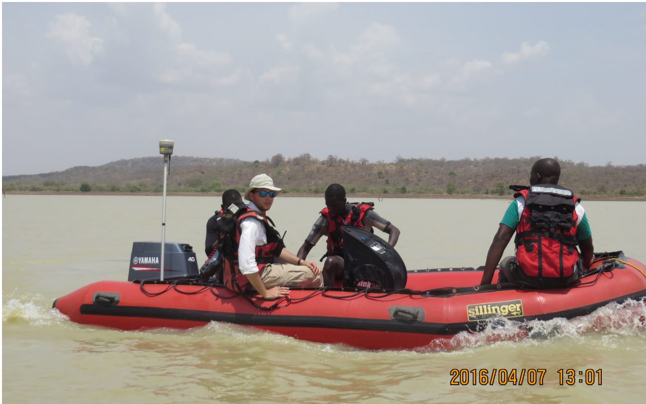
Image 3.3 – Relief bathymétrique avec le bateau
