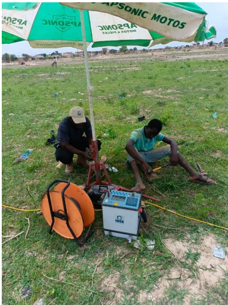
Figure 0-19 : Déploiement sur le terrain de l'équipement de tomographie de résistivité électrique (Syscal Switch Pro 72)
