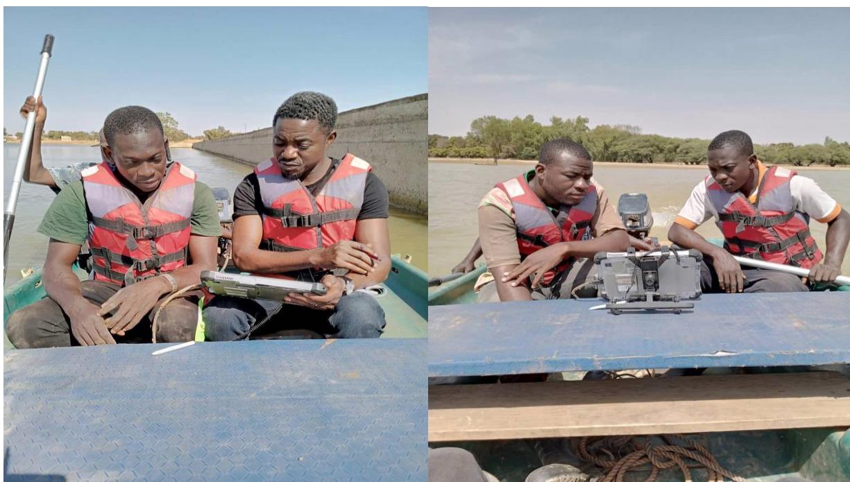
Figure 5 : travaux de levé bathymétrie avec l'échosondeur EKO EU D032
