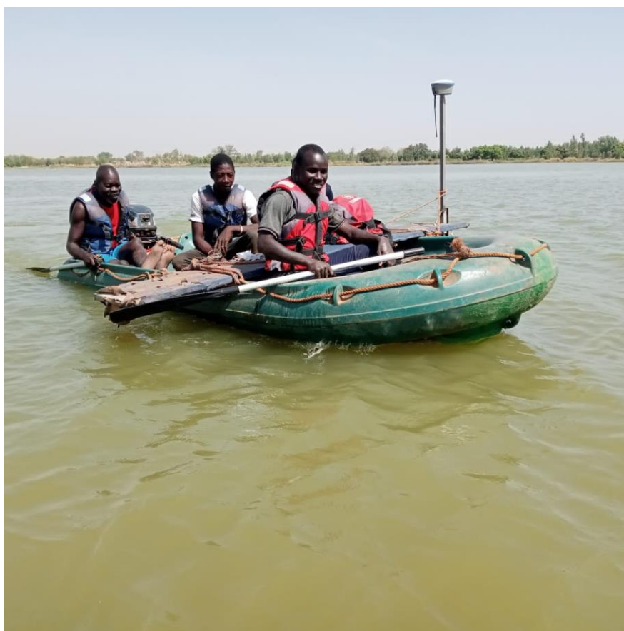
Figure 14 : Travaux de lever bathymétrie couplé échosondeur EKO EU D032 et récepteur GNSS
