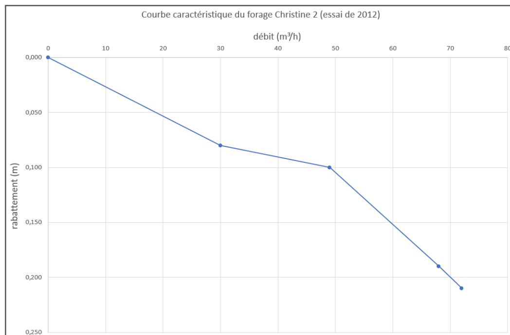
Figure 37 : Courbe caractéristique du forage Christine 2 selon l'essai de 2012 (adapté de CACI/CERTI)
