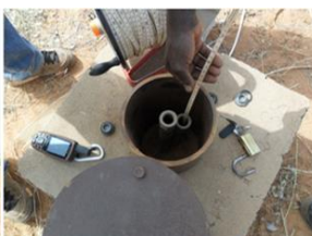
Mesure du niveau piezométrique à l'aide d'une sonde lumineuse sonore
