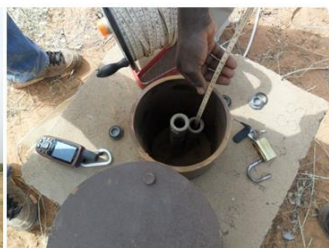
Mesure du niveau piézométrique à l'aide d'une sonde lumineuse sonore
