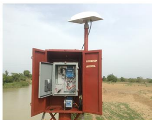
Plateforme de collectes données hydrométriques SUTRON à Télétransmission Satellitaire
