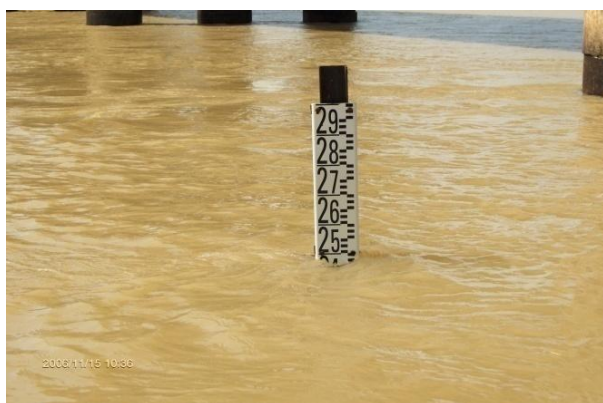
Échelle limnimétrique en station
