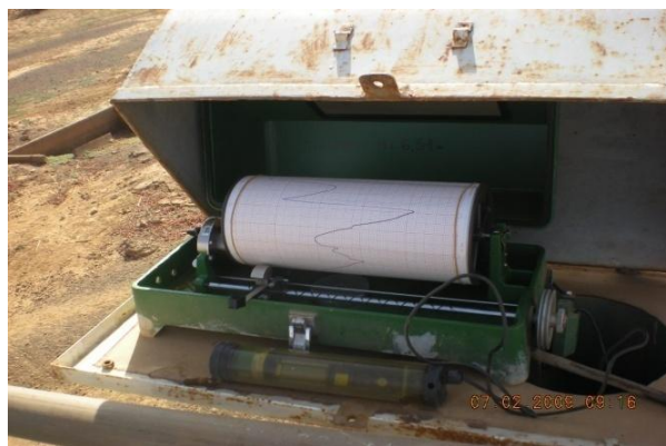
Limnigraphe enregistreur de terrain
