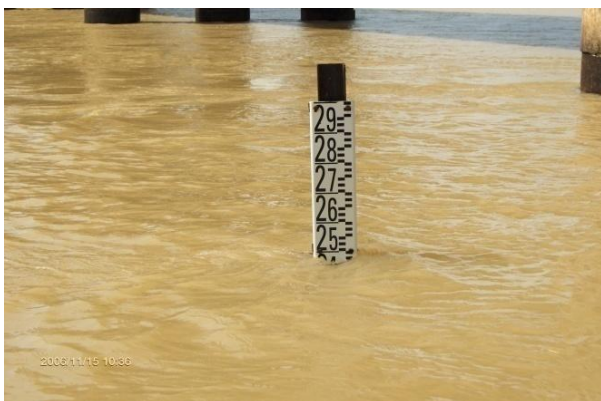
Échelle limnimétrique en station
